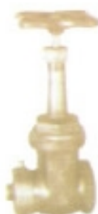
Válvula de compuerta (contra incendios) cabeza roscada, vástago ascendente, cierre de bronce a bronce, cuña solda, extremos roscables (hembra-macho) 150 Lbs./Pulg2 S.W.P. 300 Lbs./Pulg2 W.O.G. Medidas 1 1/2" Y 2 1/2".
