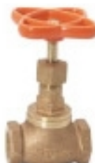
Válvula de globo cabeza roscada vástago ascendente, cierre de bronce a bronce, de 1/4" a 1/2" disco integral, disco giratorio de 3/4 en adelante extremos roscables, 125 Lbs./Pulg2 S.W.P. 200 Lbs./Pulg2 W.O.G. Medidas 1/4" a 4".
